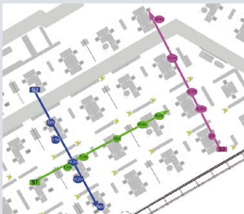
Exemplarische Messbahnen gemäß DIN EN ISO 3382-3
